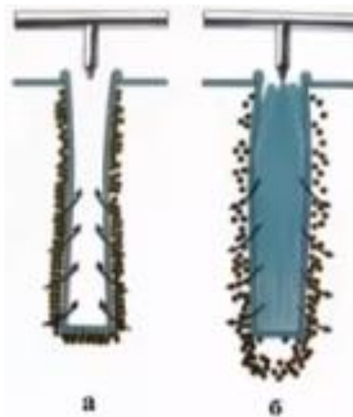
Рисунок 14 – а) Очистка от пыли рукавного фильтра; б) регенерация фильтра сжатым воздухом
